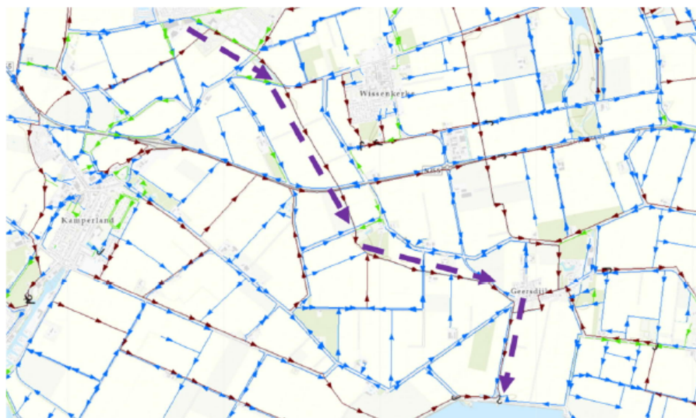
Figuur 4.4: Primaire route oppervlaktewater richting gemaal Willem weergegeven met paarse pijlen (legger waterschap Scheldestromen)
