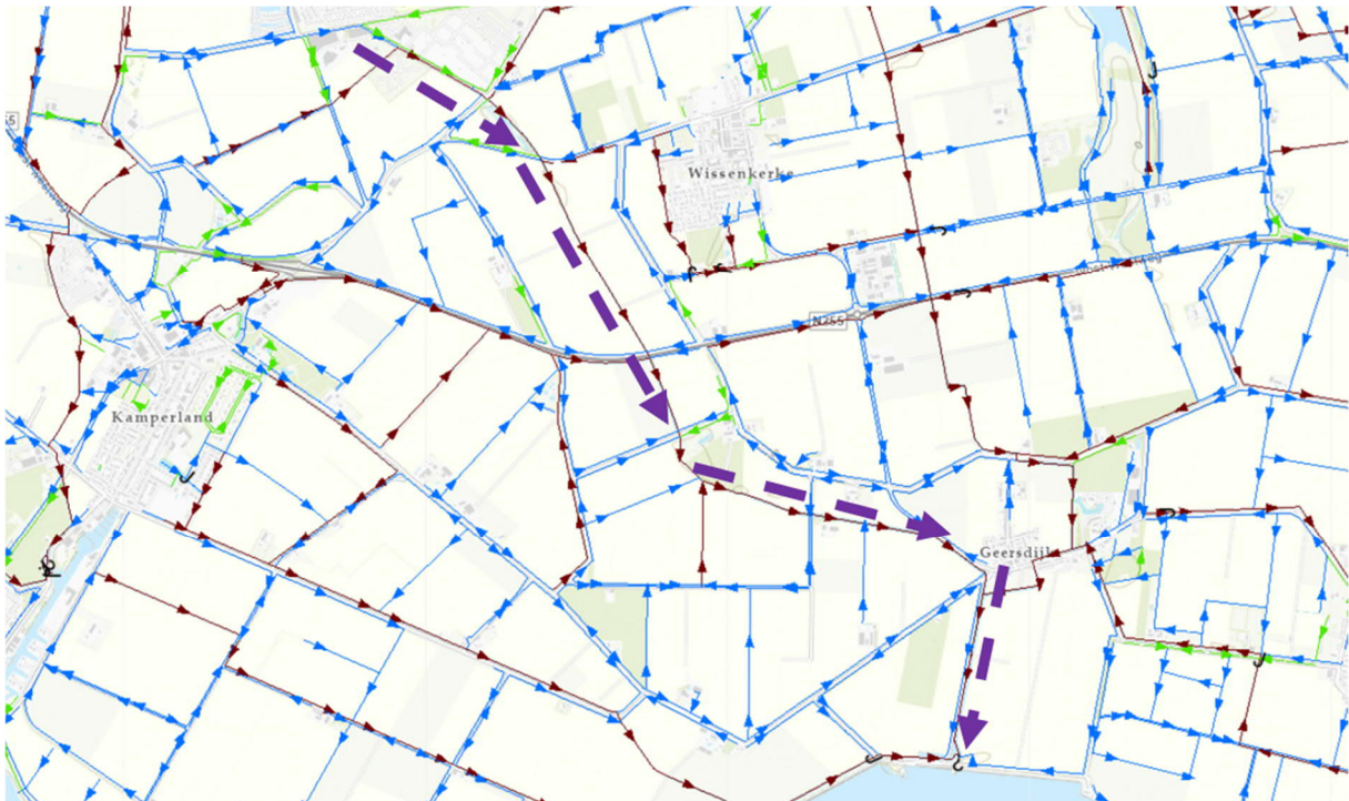
Figuur 2.7: Primaire route oppervlaktewater richting gemaal Willem weergegeven met paarse pijlen (legger waterschap Scheldestromen)
